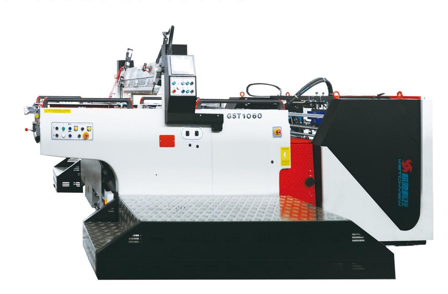
GST系列全自动停回转式丝网印刷机,吸收了成熟的胶印机技术,引进了先进的设计和生产技术,不仅能实现对UV光油的局部上光功能,还能对各种UV色墨进行单色及多色印刷,其主要针对纸品包装领域的网版印刷,该机采用经典的停回转技术,最高运转速度可达到4000张/小时,同时采用了不停机飞达及不停机收纸技术,消除了全自动丝印在上纸和出纸上的时间浪费,整机印刷利用率提升了30%,另外可根据干燥程度单独控制IV灯管的开启,收纸部分采用光电识别控制,全程实现自动化,本产线适合于陶瓷及玻璃花纸、广告、包装印刷、标牌、纺织、电子等行业的丝网印刷。
